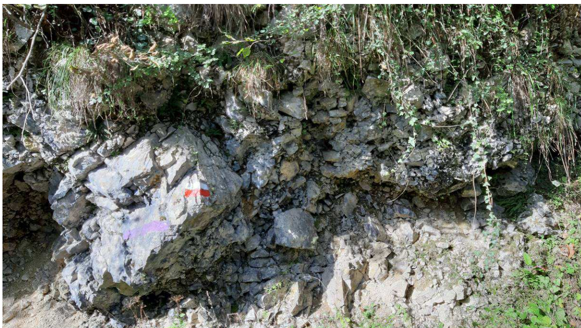
Immagine n. 5: detriti di falda cementati osservati lungo ampi tratti del sedime stradale in questione
